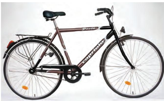
*Standardni bicikl* ima težak okvir, kotače s velikim promjrom i širinom guma 3 do 5 cm, široko sjedalo i jednostavne kočnice, može imati i mjenjač brzina, a masa mu je 14 kg ili veća. Namijenjen je za vožnju na manje udaljenosti.
